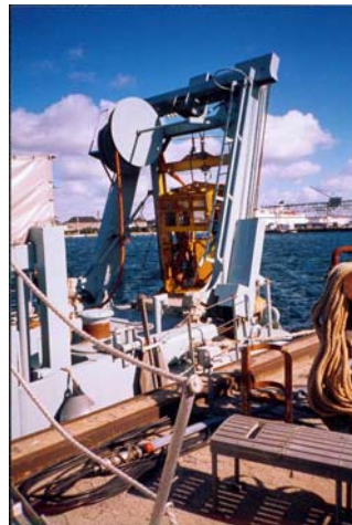
Rys. 3. Dzwony typu mokrego. (Rysunek z podręcznika firmy Comex, zdjęcie własne)
