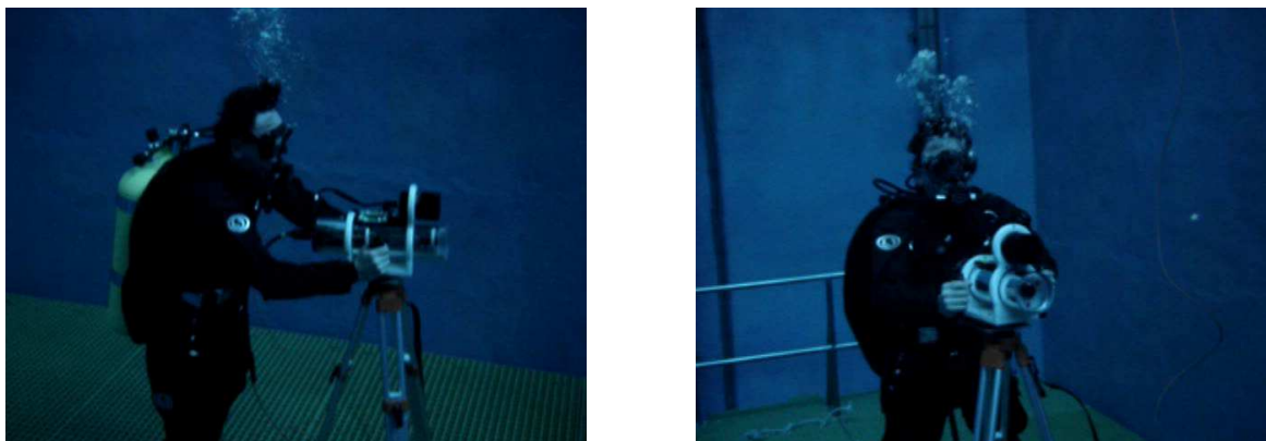
Rys. 5. Nurek obsługujący podwodną część kamery Cyklop podczas pomiarów.
