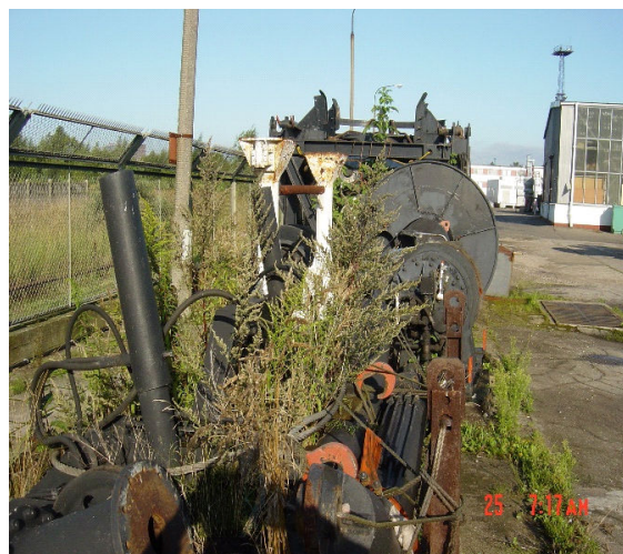
Rys. 8 Stan elementów systemu Af-2 zespołu komory i urządzenia podnośno-opustowego dzwonu w sierpniu 2003 roku.
