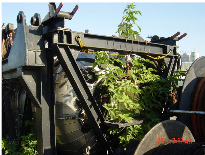
Rys. 8 Stan elementów systemu Af-2 zespołu komory i urządzenia podnośno-opustowego dzwonu w sierpniu 2003 roku.
