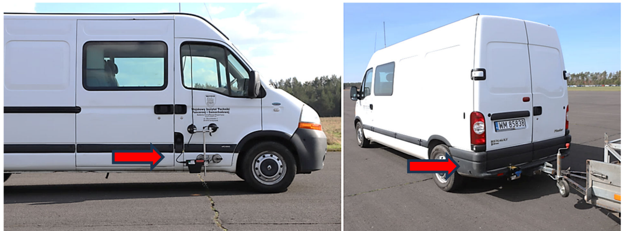
Fig. 9. Widok przyrządów pomiarowych użytych do pomiaru drogi hamowania: po lewej głowica Correxit S400, po prawej Shot Marker.
