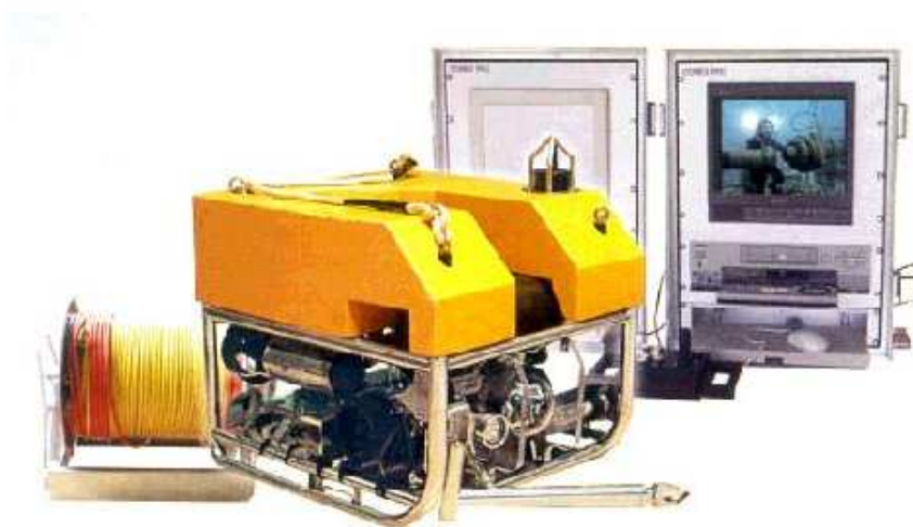
Rys. 2. Zdalnie sterowany pojazd głębinowy ROV Super Achille.
